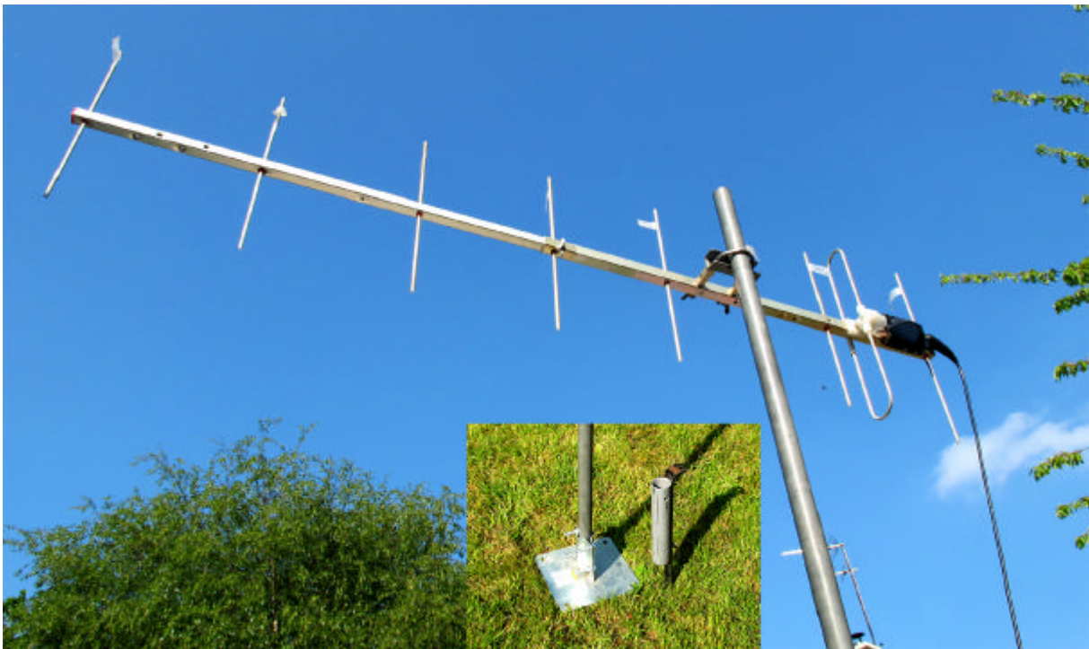
Supports : 2 tubes emboîtables avec plaque carrée ou avec tube et sa patte soudée piquée en sol. Etrier avec écrous papillon et entretoises de départ.
